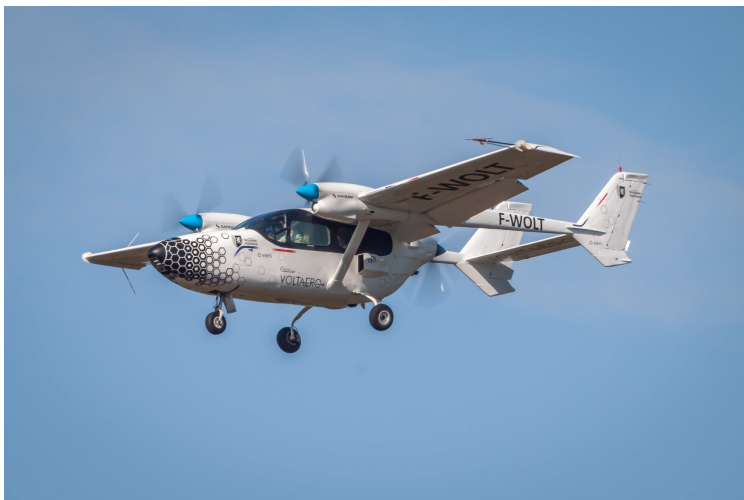
Voltaero Cassio F-WOLT. L'avion électrique, sur base de Cessna 337, a entamé une tournée de démonstration. Ici à l'atterrissage à BOD avant une démonstration devant le ministre des transports.
