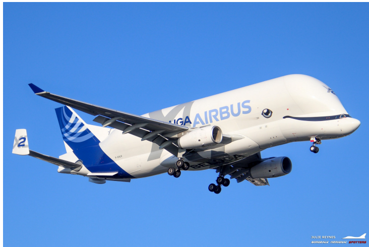
ATI Airbus Beluga XL F-GXLH. Le Beluga XL se pose enfin à Mérignac. Basé sur une cellule d'un A330, cet avion sert au transport de charges volumineuses pour Airbus Transport International.
