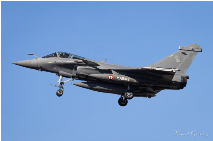
Marine Nationale/Aéronavale Dassault Rafale M n°30. En marge de l'entraînement de la PAF à Mont de Marsan, nos photographes ont eu l'agréable surprise de voir arriver un Rafale marine. L'appareil est reconnaissable à sa jambe de train avant beaucoup plus grande.
